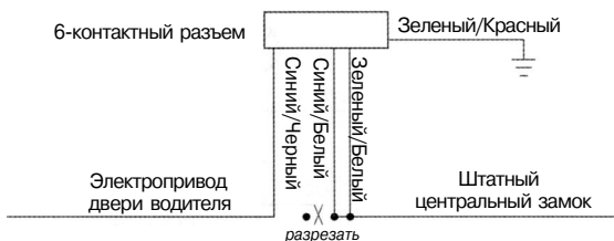
Схема 5. Однопроводная система с отрицательной полярностью (некоторые автомобили Nissan, Mitsubishi др.)
