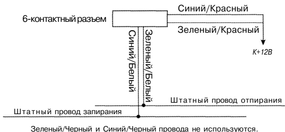
Схема 2. 3-проводная система с положительной полярностью (большинство автомобилей GM)
